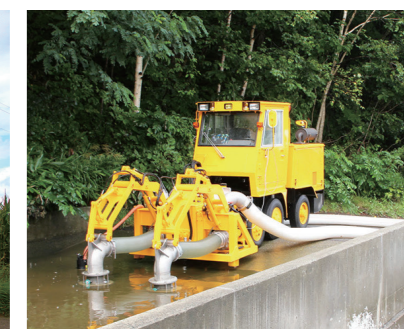
■ 排水ポンプ装置
