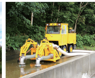
■ 排水ポンプ装置
