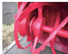
●運転室内操作復帰型 オーガシャーピンレス装置（油圧クラッチ式）
