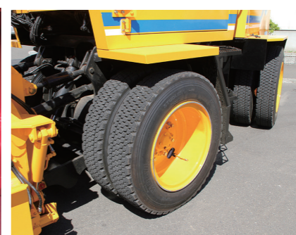
■ 前後輪ダブルタイヤ仕様 (1.8m幅仕様に装備可能)
