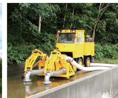
■ 排水ポンプ装置
