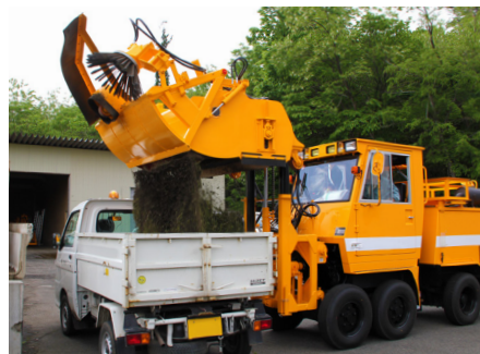
●集めた砂塵のトラック積込作業
