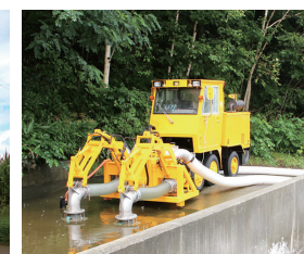
■排水ポンプ装置
