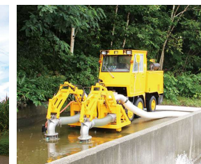
■排水ポンプ装置
