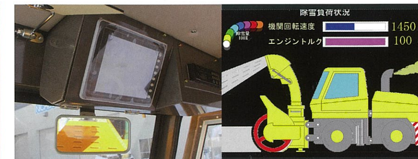
■ 車両状態確認モニタ仕様 (除雪負荷表示画面)
