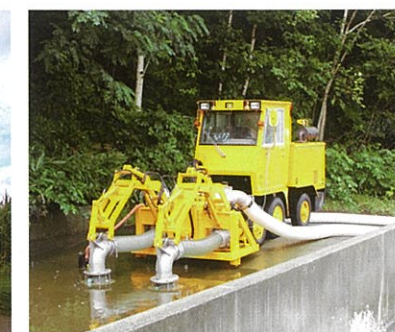
■ 排水ポンプ装置
