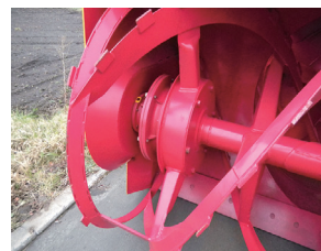
●運転室内操作復帰型 オーガシャープレス装置(油圧クラッチ式)
