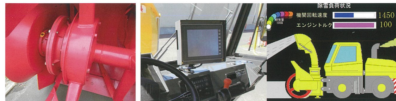
■ 運転室内操作復帰型 オーガシャーピンレス装置仕様 (油圧クラッチ式)
