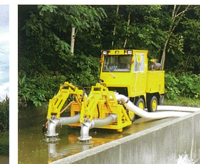
■ 排水ポンプ装置
