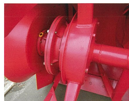
■ 運転室内操作復帰型 オーガシャーピンレス装置仕様 (油圧クラッチ式)
