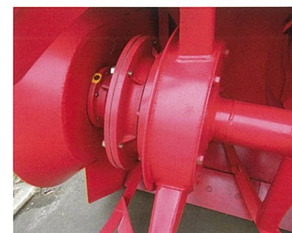
■ 運転室内操作復帰型 オーガシャーピルス装置仕様 (油圧クラッチ式)
