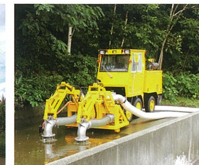
■ 排水ポンプ装置
