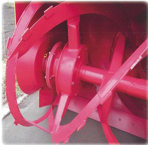
●オーガ油圧クラッチ式シャーペンレス装置仕様 (運転室内操作復帰型)
