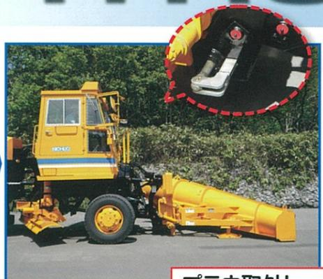
ブレード取外し ~ 装着ピン解除
